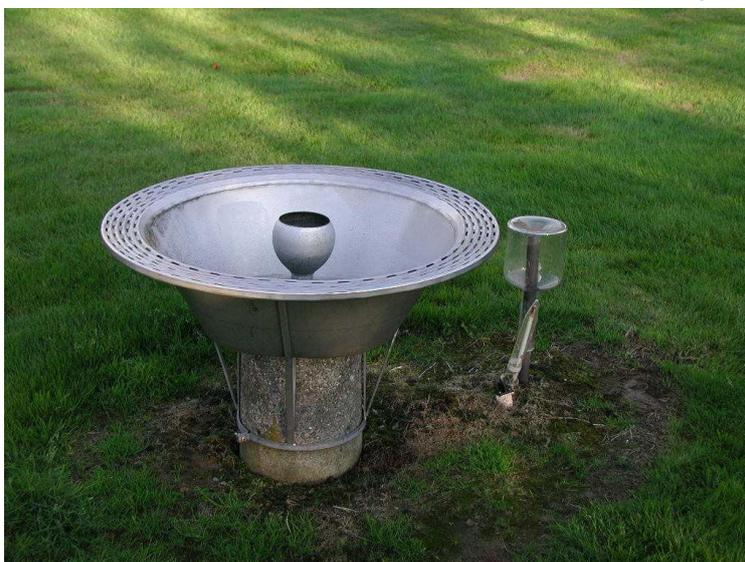
A partir de 1898, un pluviographe est installé dans le parc climatologique à Uccle, près du pluviomètre manuel (cf. figure 2.2). Cet appareil à siphon a donné un enregistrement en continu des précipitations
