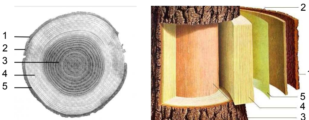
Composition d'un tronc: (1) écorce, (2) liber, (3) bois de coeur, (4) bois d'aubier, (5) cambium
