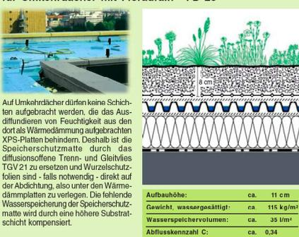
Auf Umkehrdächern dürfen keine Schichten aufgebracht werden, die das Ausdiffundieren von Feuchtigkeit aus den dort als Wärmedämmung aufgetragenen XPS-Platten behindern. Deshalb ist die Speicherschutzmatte durch das diffusionsoffene Trenn- und Gleitvlies TGV 21 zu ersetzen und Wurzelschutzfolien sind - falls notwendig - direkt auf der Abdichtung, also unter den Wärmedämmplatten zu verlegen. Die fehlende Wasserspeicherung der Speicherschutzmatte wird durch eine höhere Substratschicht kompensiert.
