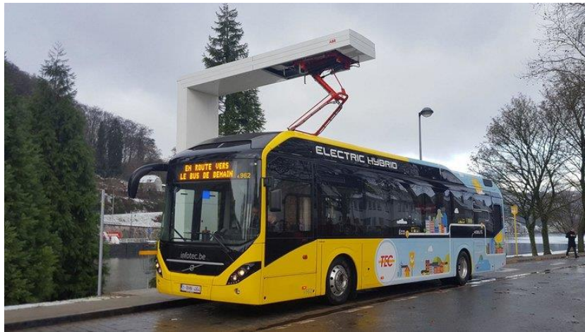
Figuur 11 – Een pantograafsnellaadstation voor bussen in Göthenburg (Volvo)
