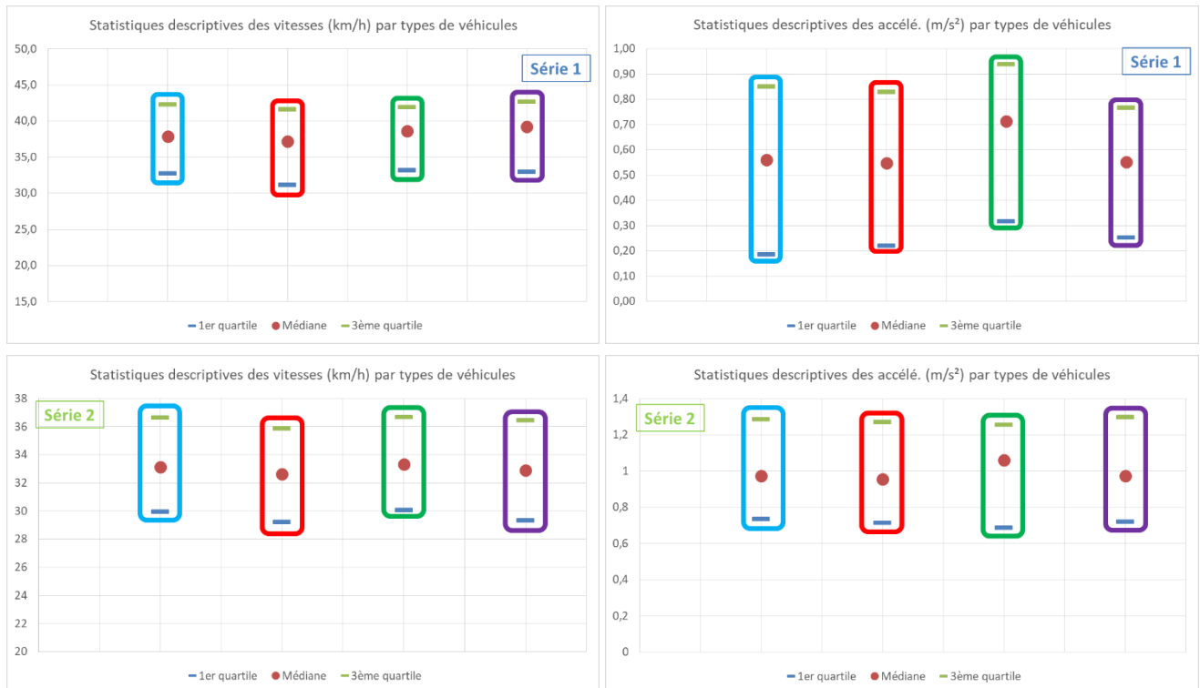
Figure 17 : Statistiques descriptives des vitesses (à gauche) et des accélérations (à droite) pour la série 1 (dessus) et la série 2 (dessous) par types de moteur des véhicules : essence, diesel, électrique et hybride.
