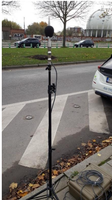
Figure 3 : Matériel de mesure acoustique à l'endroit de mesure BRU001a : microphone déporté avec sa boule anti-vent, mât et valise étanche.
