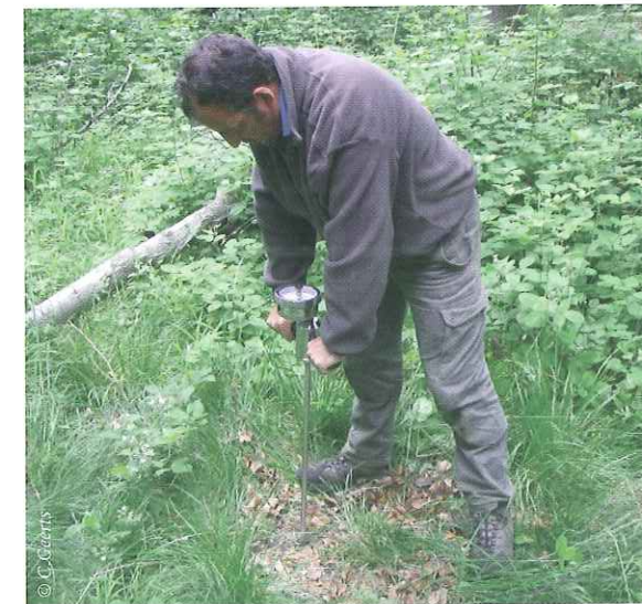
Utilisation du pénétromètre afin de quantifier la compaction du fragipan, ainsi que sa profondeur d'apparition.
