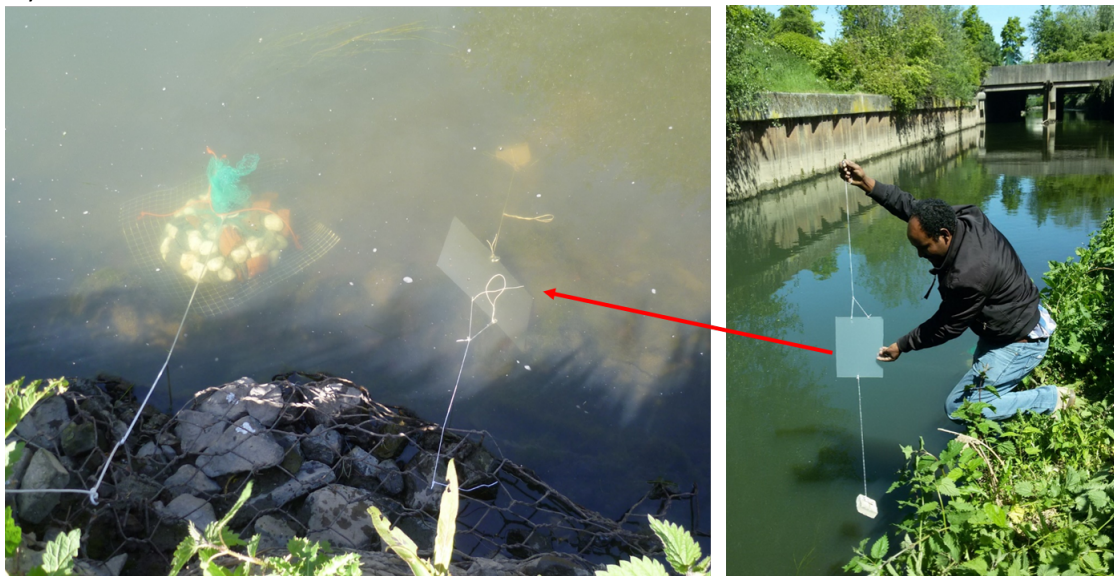
Figuur 7: Artificieel substraat uitgehagen aan S1, binnen de eufotische zone. Uiterst rechts het stenig substraat voor macroinvertebraten en links het plastic substraat voor fytobenthos kolonisatie
