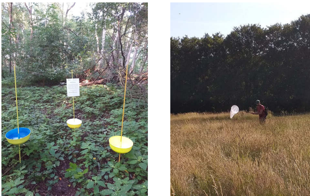
Figure 2 : Dispositif de piégeage des pollinisateurs passif au moyen de trio de Pantraps colorés (à gauche) et méthode de piégeage active au filet entomologique (à droite)
