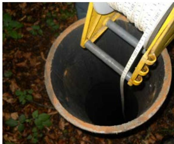
Exemple de piézomètre où la mesure du niveau piézométrique est faite à l'aide d'une sonde manuelle. Source : Bruxelles Environnement.
