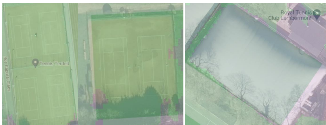
Figure 1: A gauche : Court de tennis non couvert en terre battue classé perméable (Tennis Terdelt). Centre : Court de tennis non couvert en gazon classé perméable (Brussels Lawn Tennis Club). A droite : Terrain de tennis couvert classé imperméable (Royal Tennis Club Lambermont).
