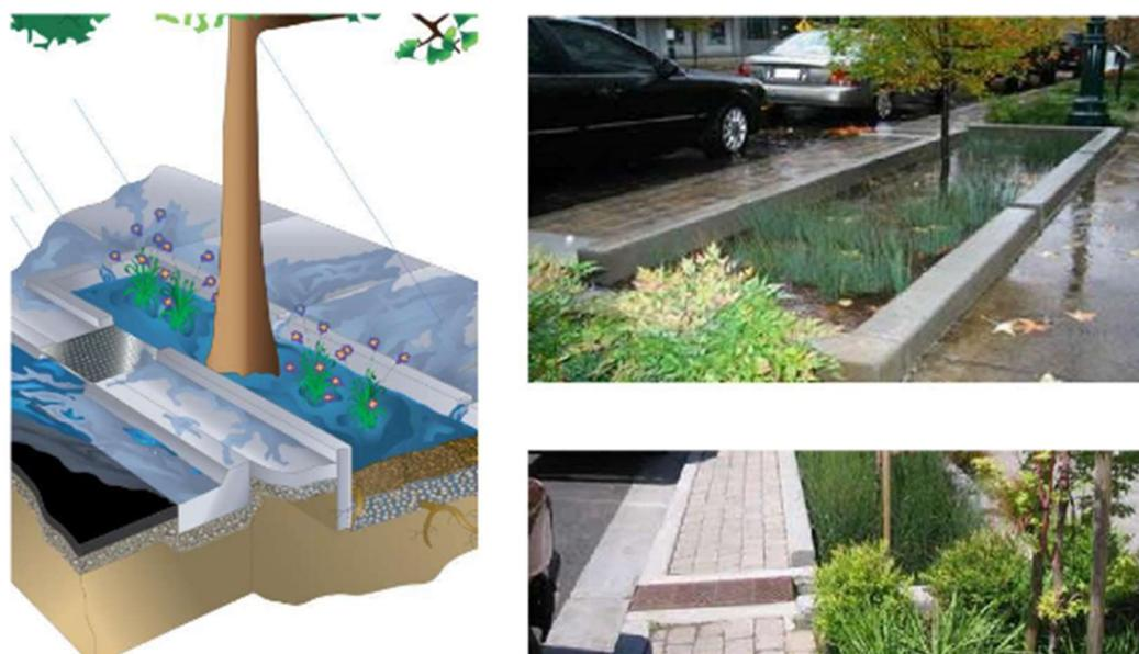
Figure 2 : les fosses d'eau pluviale agissent comme des mini réservoirs au pied des arbres de pluie (Source: EPA, Stormwater to street trees)
