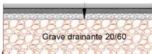
van een verharde rijweg op een afwateringsstructuur (IS)
