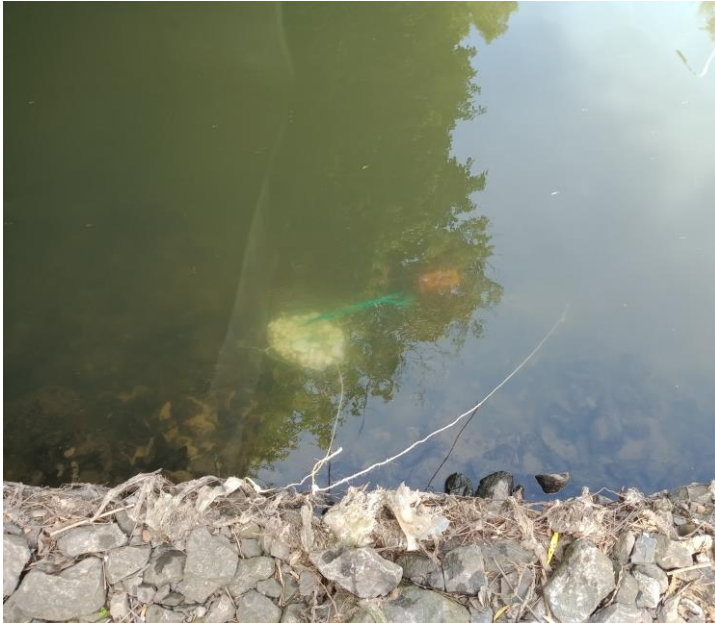
FIGUUR 3.1: Staalname met artificieel substraat in het kanaal en de Zenne. Een stuk plastic wordt via een touw vastgemaakt aan de oever (rechtertouw) en daar 4 tot 5 weken in het water gehangen. In die periode krijgt het fyto-benthos in het waterlichaam de kans om het artificieel substraat te koloniseren. Links hangt het artificieel substraat voor de macro-invertebratenstaalname.
