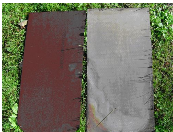
Rechts een leisteen van asbestcement (gewafelde textuur) en links een leisteen zonder asbest (met 'NT'-vermelding)
