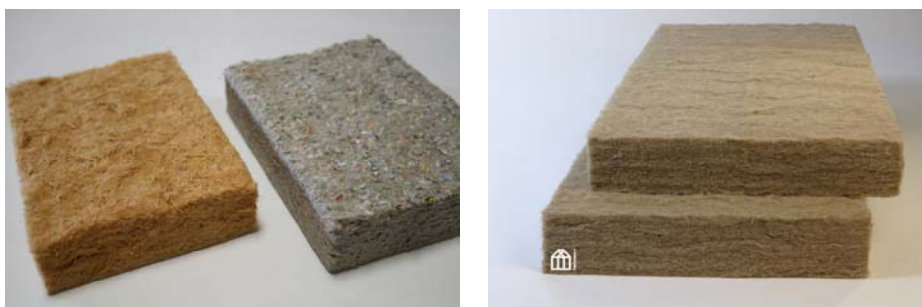
A gauche: matériaux d'isolation recyclables en fibre de bois (g) et flocons de papier (dr) fabriqués à partir de matériaux de recyclage
