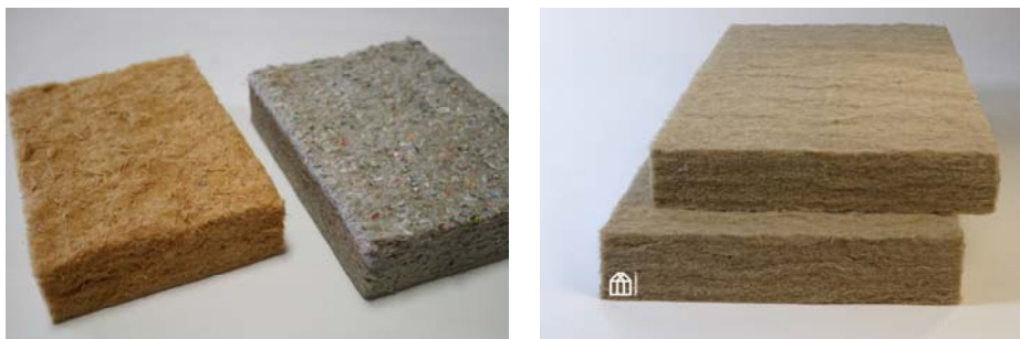
Links: nagroeibaar isolatiemateriaal uit houtvezel (l) en papiervlokken (r) vervaardigd uit recyclagemateriaal
