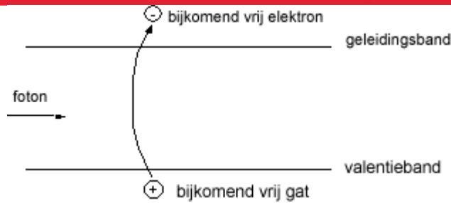
Figuur 2: Het invallende foton creëert een elektron/gat-paar
