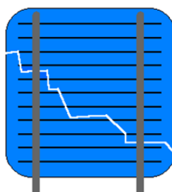
Figuur 3 : Gescheurde cel toch kan functioneren dankzij de contactstrips
