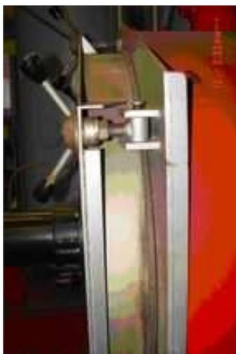
**Figure 4.3.7: Corde sur la porte d'une chaudière**
