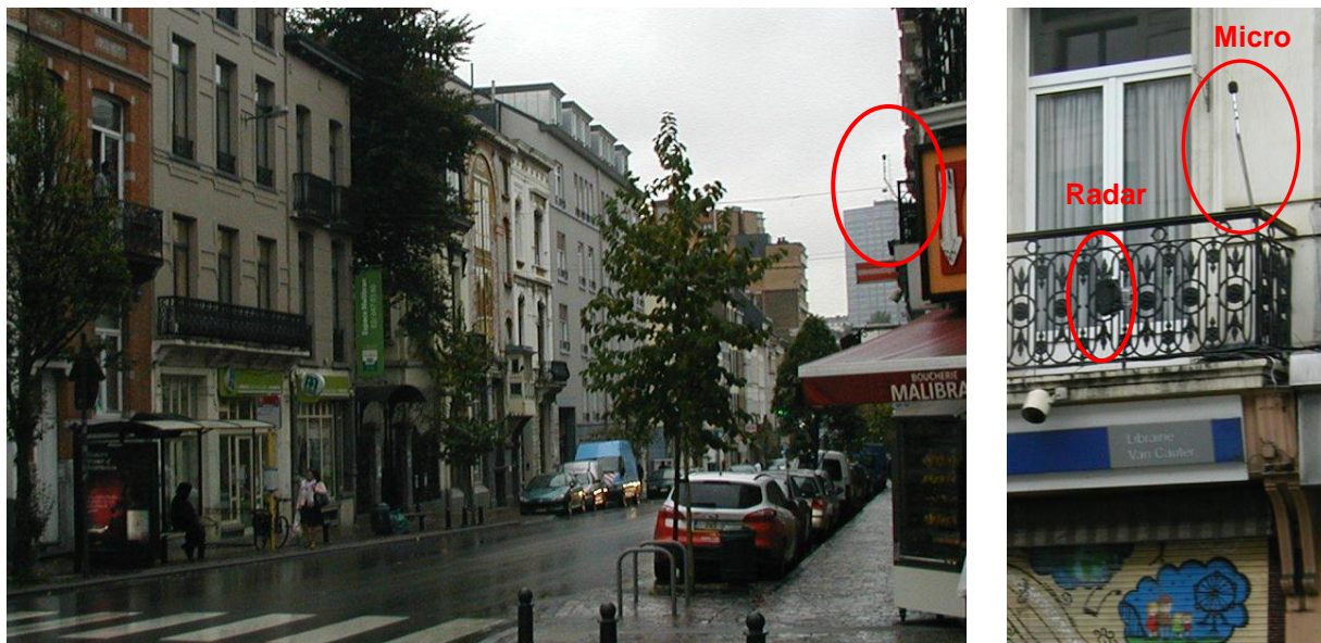
Implantation du sonomètre (Photos Bruxelles Environnement)
