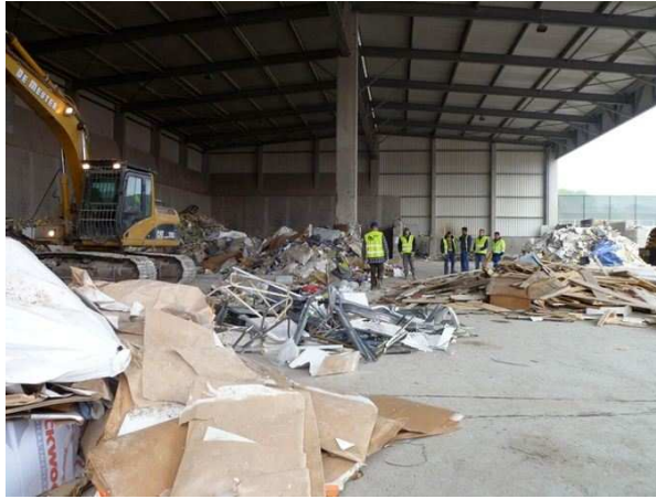
Illustration 53 : Vue générale du hangar de tri. A l'avant plan, le carton, les métaux et le bois extraits des déchets mélangés
