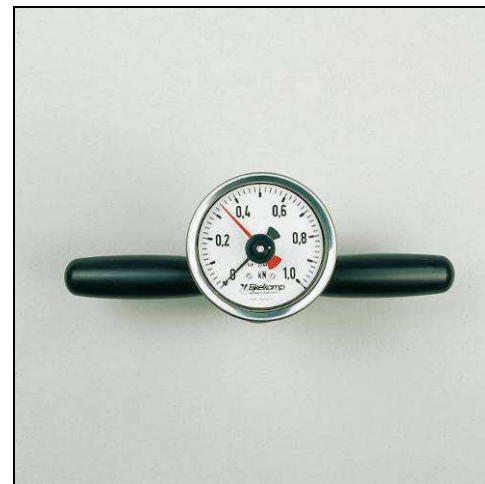
Figure 41 - Pénétrömètre vendu par l'entreprise Eijkelkamp, composé d'un manomètre, de tiges et de cônes de sections différentes.
