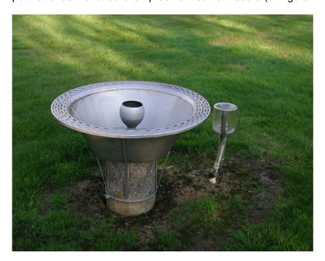
**Figure 1.1.2.1.** Le pluviomètre manuel P50 relevé chaque matin à Uccle pour connaître le cumul journalier des précipitations. La mesure de la quantité d'eau tombée est effectuée en vidant la bouteille dans une éprouvette finement graduée (mesure au dixième de mm ou l/m²). Par temps de neige, la bouteille et l'entonnoir sont remplacés par un nivomètre d'ouverture identique qui permet une meilleure récolte des flocons de neige.
