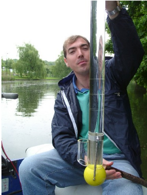
Staalnamebuis voor fytoplankton.
