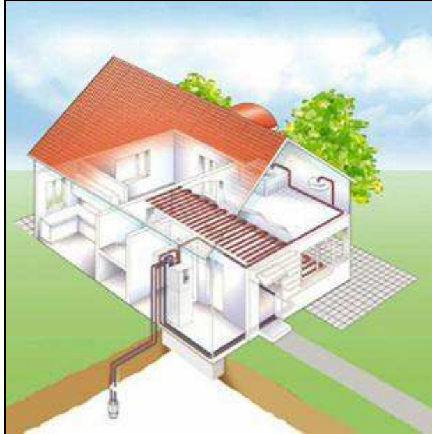
Figuur 8: Principe warmteonttrekking met verticale wisselaars [6]
