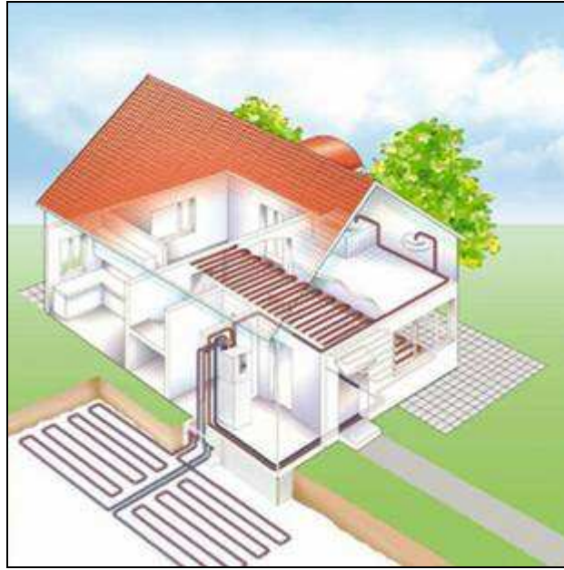
Figuur 6: Principe horizontale bodemwarmtewisselaars [6]
