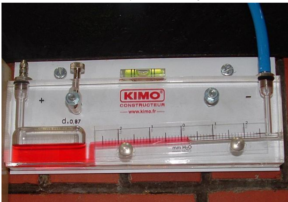
Figuur 4.3 Meting vervuiling van een filter
