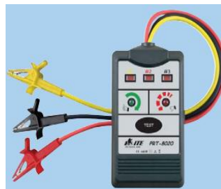
Figuur 6.15 Voorbeeld van een tester van de draairichting met snoeren
