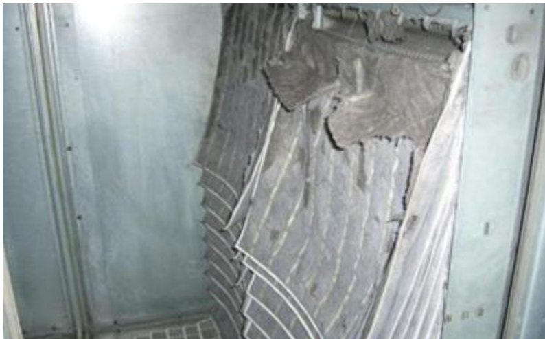
Figuur 2.5 gescheurd zakfilter
