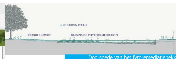
Doorsnede van het fytoremediatiebekken
