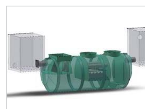
Schematische weergave van een ter plaatse gerealiseerd lamellenindikker
