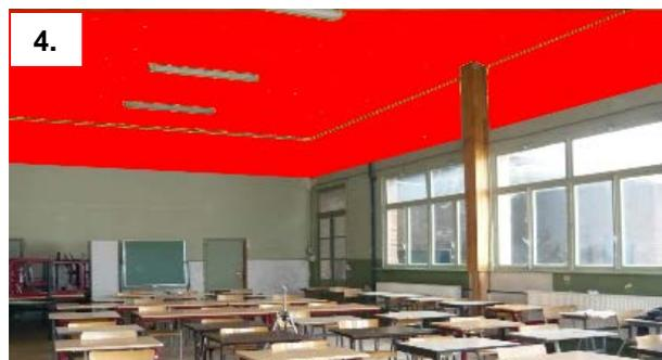
Photo 3 : Les solutions proposées par Bruxelles Environnement afin de diminuer les problèmes de réverbération (1. Préaux couverts, 2. et 3. Salles de sports, 4. Réfectoires) se traduisent essentiellement par la pose de panneaux absorbants aux plafonds et aux murs. (Source : Bruxelles Environnement, Fiche 34. Exposition au bruit dans les écoles, 2012, 11p.).
