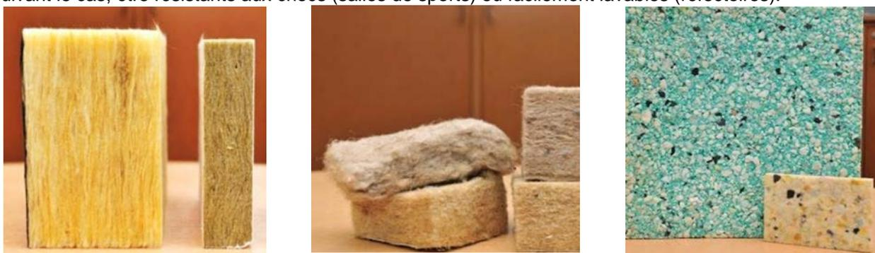
Photo 6 : Les laines minérales ou naturelles ainsi que les déchets de polyuréthane recyclés sont de bons matériaux absorbants (Source photo : Centre Urbain).
