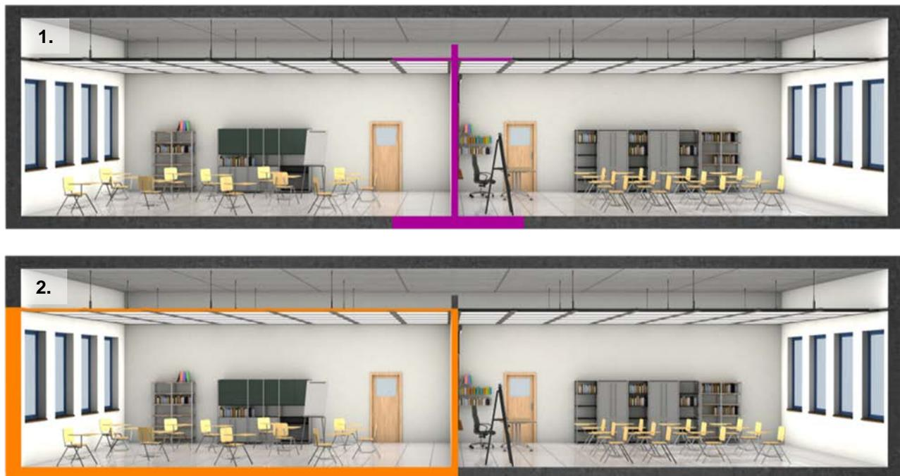
Figure 9 : L'amélioration de l'isolation et du temps de réverbération dans les locaux se basent sur deux principes différents : 1. L'isolation acoustique (réduction de la transmission du bruit entre deux locaux) et 2. La correction acoustique (réduction de la réverbération à l'intérieur d'un même local).
