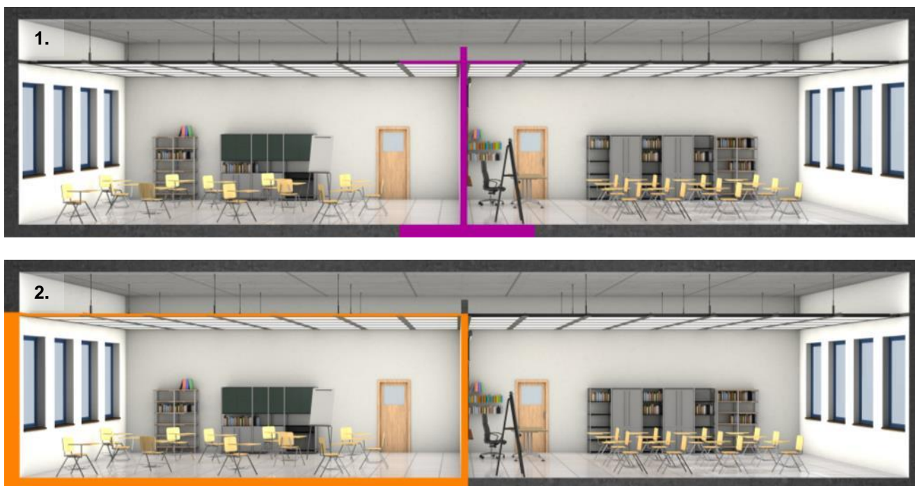
Figuur 9 : De isolatie en de nagalmtijd kunnen verbeterd worden op twee manieren: 1. geluidsisolatie (beperking van de overbrenging van het geluid tussen twee lokalen) en 2. akoestische correctie (beperking van de nagalm binnen eenzelfde lokaal).
