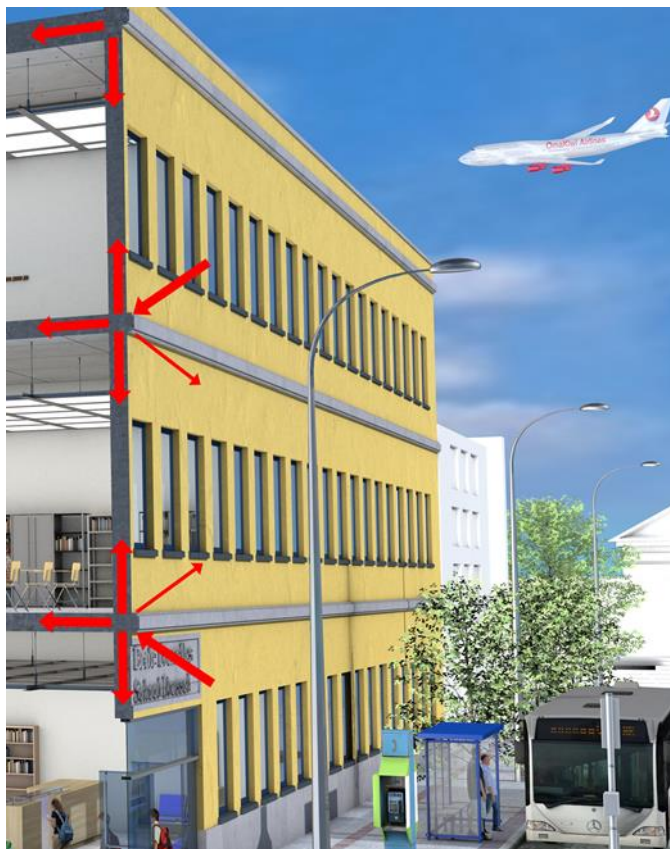
Figuur 18 : Als de gevel slecht geïsoleerd is, kan geluid van buiten (vliegtuigen, wegverkeer, ...) het gebouw binnendringen.
