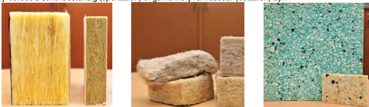
foto 6 : Minerale of natuurwol en gerecycleerd polyurethaanafval zijn goede absorberende materialen (Bron foto: Stadswinkel).
