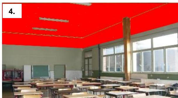
foto 3 : De oplossingen die Leefmilieu Brussel voorstelt om de nagalmproblemen te verminderen (1. binnenspeelplaatsen, 2. en 3. sportzalen, 4. eetzaalen) berusten doorgaans op de plaatsing van absorberende panelen tegen plafonds en muren. (Bron: Leefmilieu Brussel, Fiche 34. Blootstelling aan geluidsoverlast in de scholen, 2012, 11 p.).
