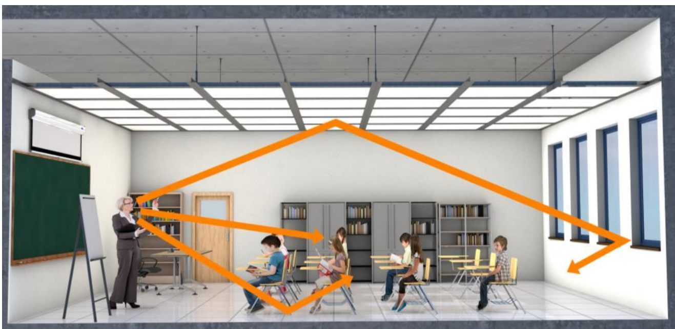
Figuur 7 : De lokalen met een groot volume en materialen die het geluid weerkaatsen, zoals tegels of ruiten, geven nagalmproblemen omdat de geluiden weerkaatst worden door muren, plafonds en vloeren.
