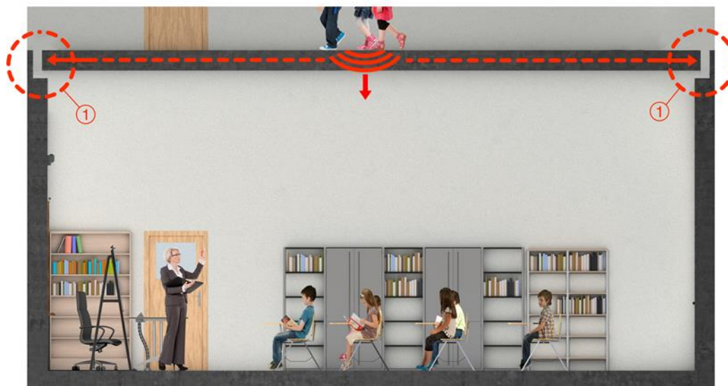
Figuur 20 : De ontkoppeling maakt het mogelijk lokalen van elkaar te scheiden en de overdracht van contactgeluiden in het gebouw te beperken.
