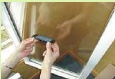
Figure 40 : Vitromètres - les cercles tangents indiquent l'épaisseur du verre (sources : Energy+ et Prismaver)
