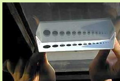
Figure 40 : Vitromètres - les cercles tangents indiquent l'épaisseur du verre (sources : Energy+ et Prismaver)
