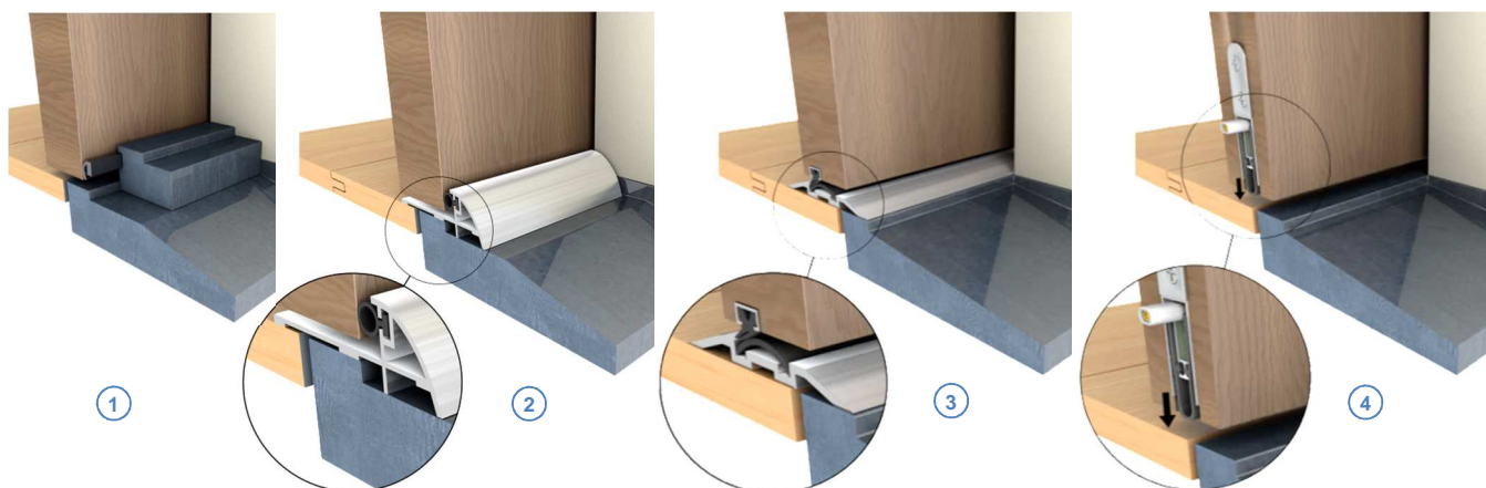
Figuur 44 : Prestatie dorpelen types : (1) Aanslag met luchtdichte voeg - (2) "Zwitserse" dorpel - (3) Tussendorpel + slab - (4) Guillotinedichting
