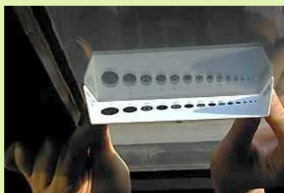
Figuur 40 : Vitrometers - de raakcirkels geven de glassdiktes aan (bron: Energy+ et Prismaver)
