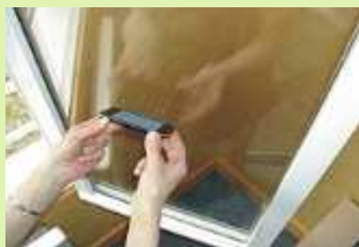
Figuur 40 : Vitrometers - de raakcirkels geven de glassdiktes aan (bron: Energy+ et Prismaver)
