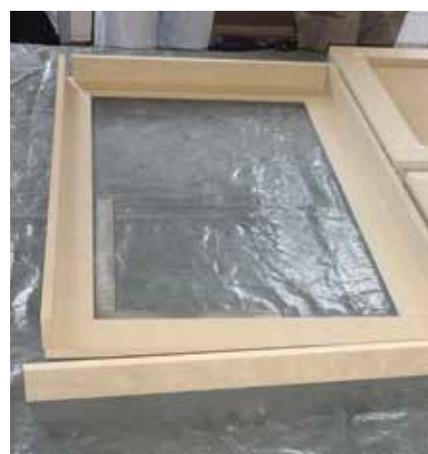
**2. Pré-trouez les lattes** sur chaque angle, à l'endroit indiqué sur le schéma.
