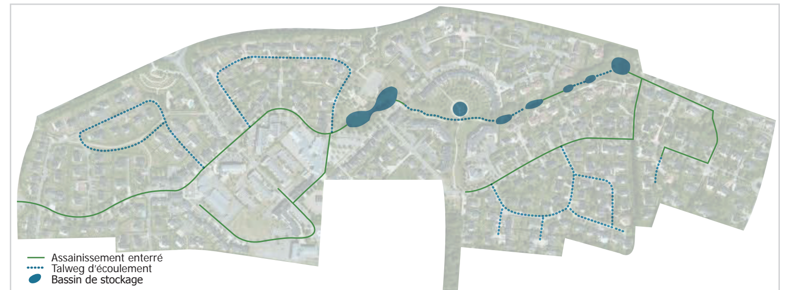
Schéma hydraulique de l'opération
