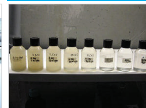
Tests d'eau de voirie avant, pendant et après d'être traitées avec le filtre de Double Porosité
