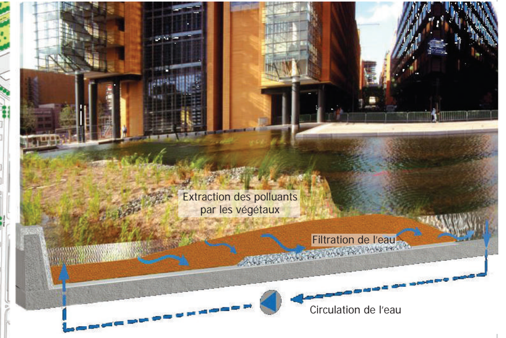
Principe de dépollution de l'eau de pluie
