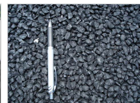
Chaussée à revêtement poreux
