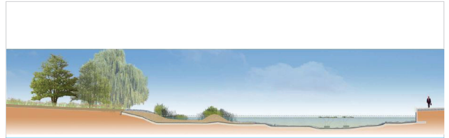
Coupe de principe d'un bassin de rétention
