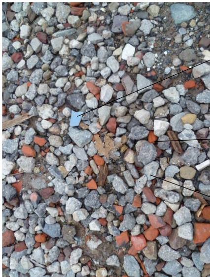
Granulats recyclés de débris mixtes 0/40 mm :
