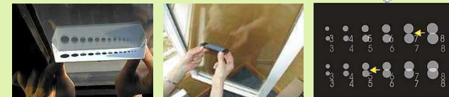
Figure 40 : Vitromètres - les cercles tangents indiquent l'épaisseur du verre (sources : Energy+ et Prismaver)
