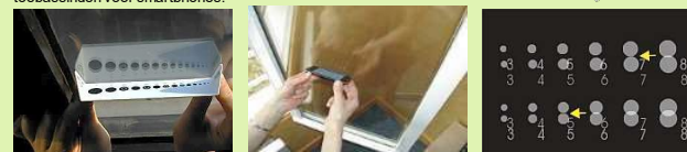
Figuur 40 : Vitrometers - de raakcirkels geven de glasdiktes aan (bron: Energy+ et Prismaver)
