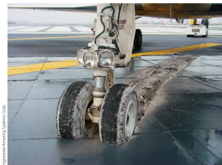
Figure 73. Avion stoppé par un EMAS
