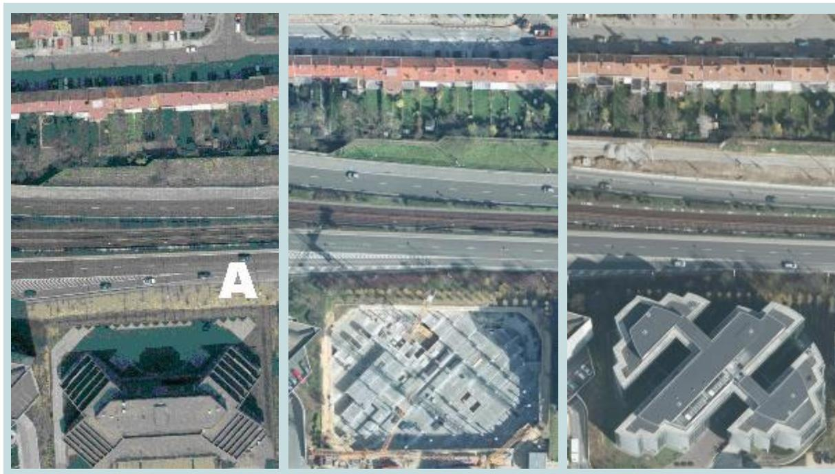
Le niveau de bruit  $L_d$  (de 7h00 à 19h00) relevé en avril 2001 au point de mesure A était de 62,7 dB(A). Lors de la deuxième campagne de mesures réalisée en mars 2010, il était de 53,3 dB(A), soit un gain de 9,4 dB(A), ce qui est considérable pour des conditions de trafic considérées comme inchangées. Les points de mesures réalisés de l'autre côté de la E411, à l'arrière des habitations de l'avenue des Meuniers enregistraient pour leur part un gain de 1,5 à 2 dB(A).
