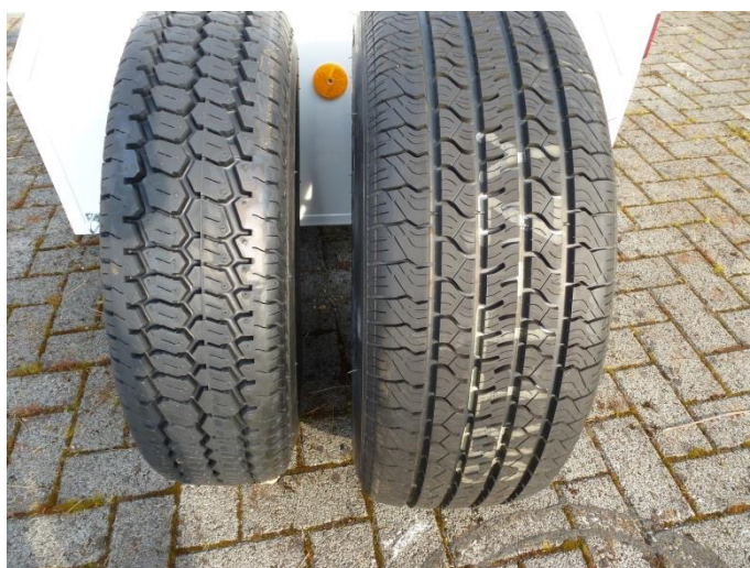
Figuur 60 - SRTT- en Avon AV4-meetbanden.
