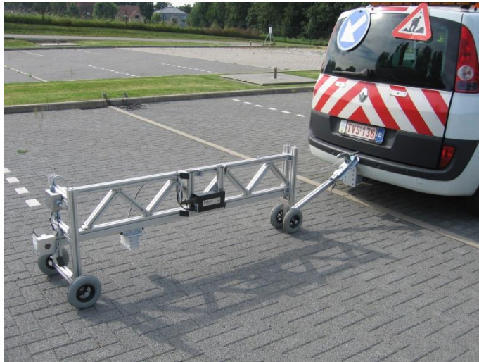
Figuur 30 - de laserprofilometer van het O.C.W.
