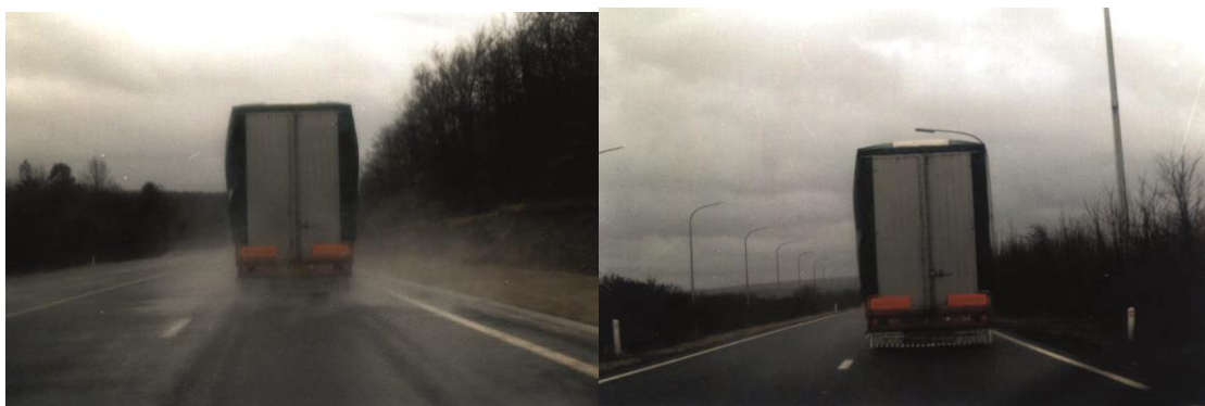
Figuur 68 - stuifwater bij een dicht wegdek en de quasi-afwezigheid ervan bij een poreus wegdek.
