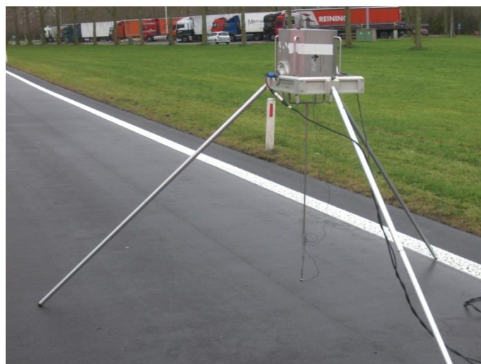
Figuur 66 - M+P meetsysteem voor absorptiemetingen van een wegdek.
