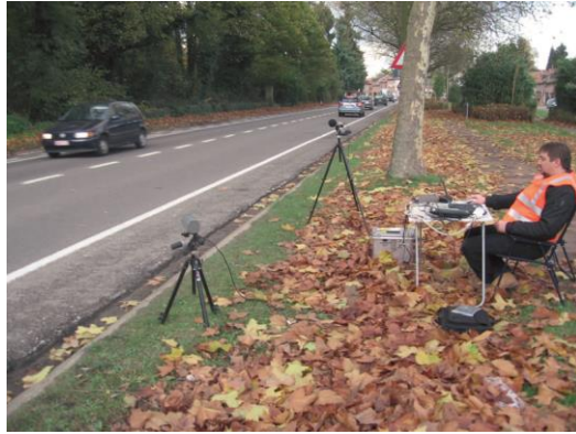
Figuur 51 - meetopstelling voor een statistical pass by meting (SPB).
