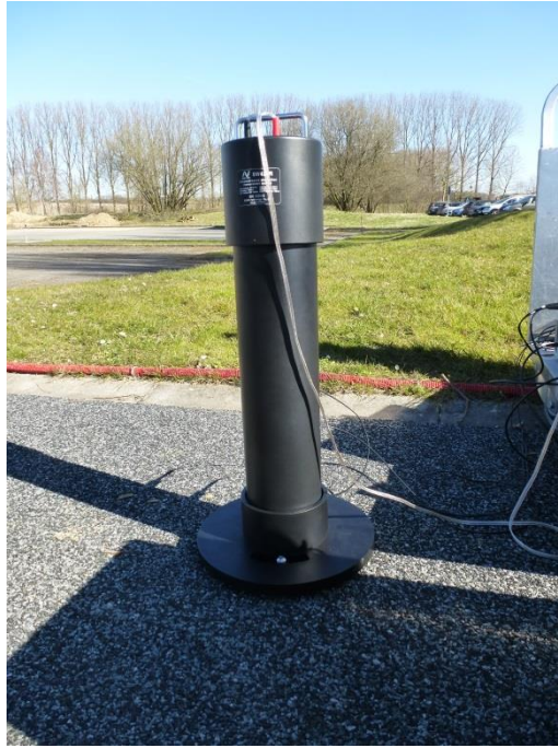
Figuur 65 - impedantiebus voor het meten van de absorptie van een wegdek (Universiteit Antwerpen).
