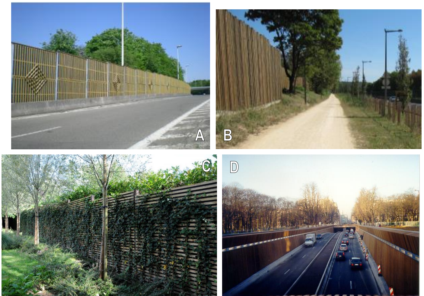
Figure 61 – Dispositifs absorbants en bois: A, B et C = écrans, C avec plantations, D = revêtements de parois
