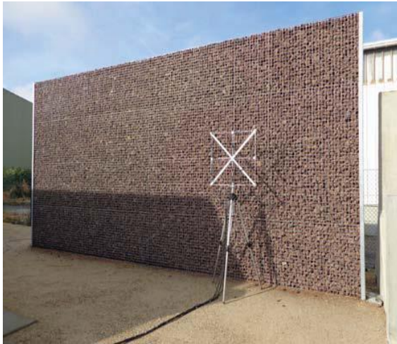
Figuur 74 – Voorbeeld van geluidsscherm met schanskorven met uitstekende geluidsabsorberende en -isolerende prestaties (bron: vbion.com )
