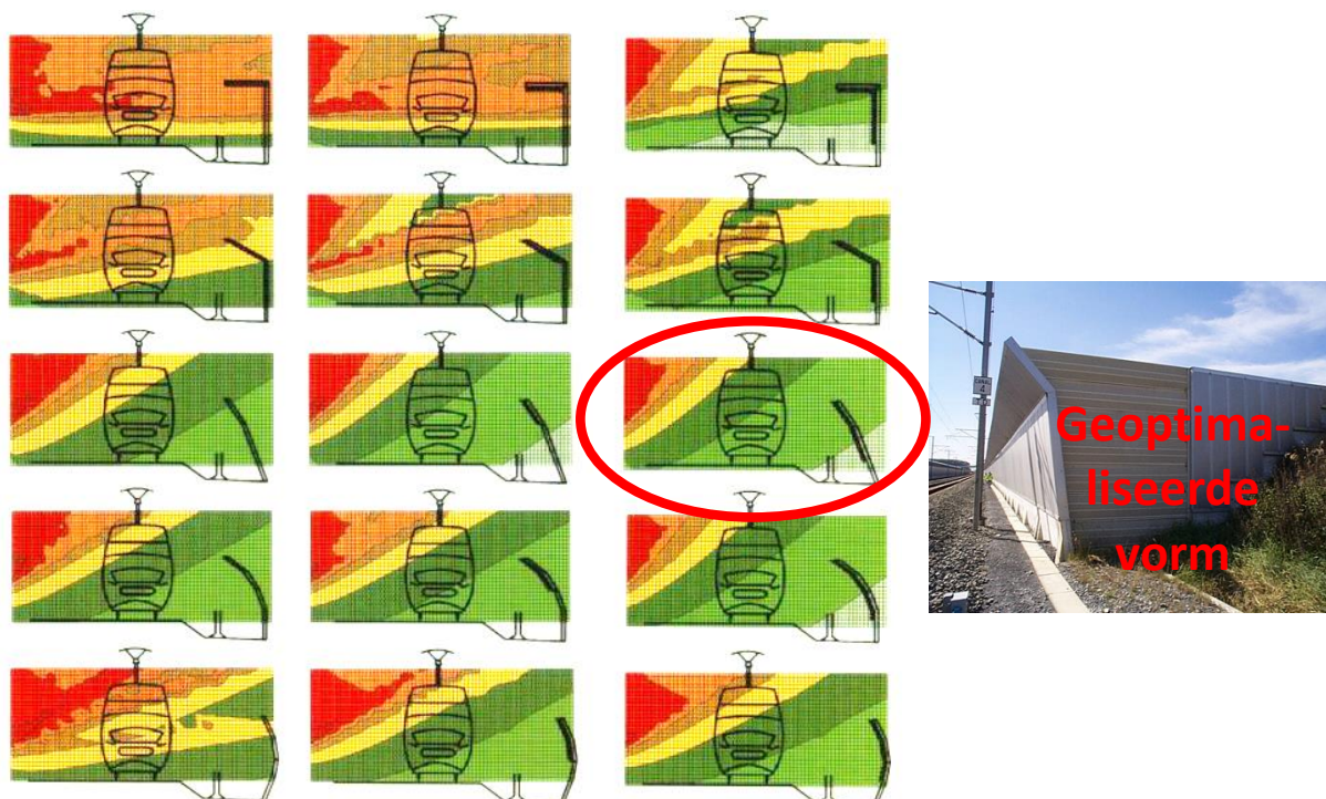
Figuur 46 – Geluidskarten (-15 m tot +45 m boven het spoor en 10 m tot 150 m rechts naast het spoor) als functie van de soort van geluidsscherm voor een hogesnelheidslijn (vormgeving en geluidsabsorberende kenmerken)
