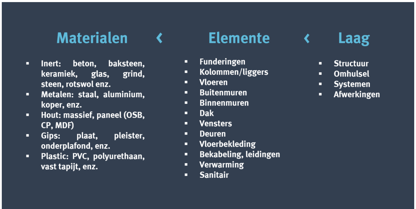
Figuur 10: Alle materialen, elementen en lagen die in aanmerking worden genomen voor de materiaalvoorraad van de Brusselse gebouwen. Bron (auteur).
