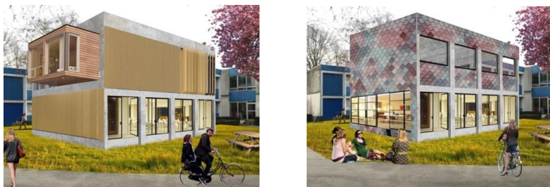
Figuur 23: Transformatievoorbeelden van de prefab betonmodules 90 .
