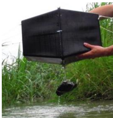
Foto 1: Kooi gebruik voor actieve biomonitoring met karper.
