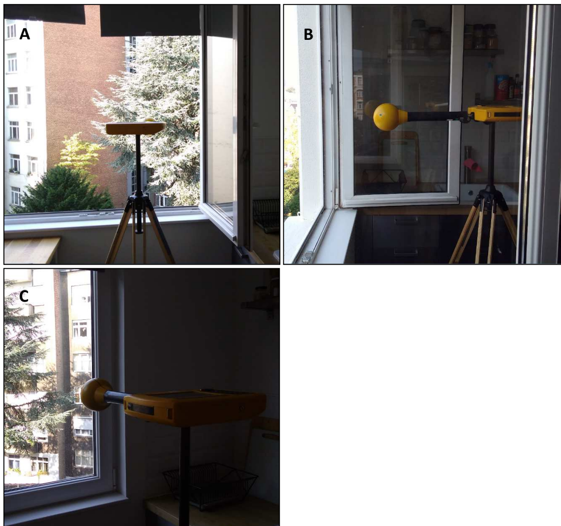
Figure 24 : Exemple d'installation du mesureur selon les trois types de mesures systématiques. A : dans le plan de la fenêtre, ouverte ; B : à 50cm de la fenêtre, ouverte ; C : à 50cm de la fenêtre, fermée.
