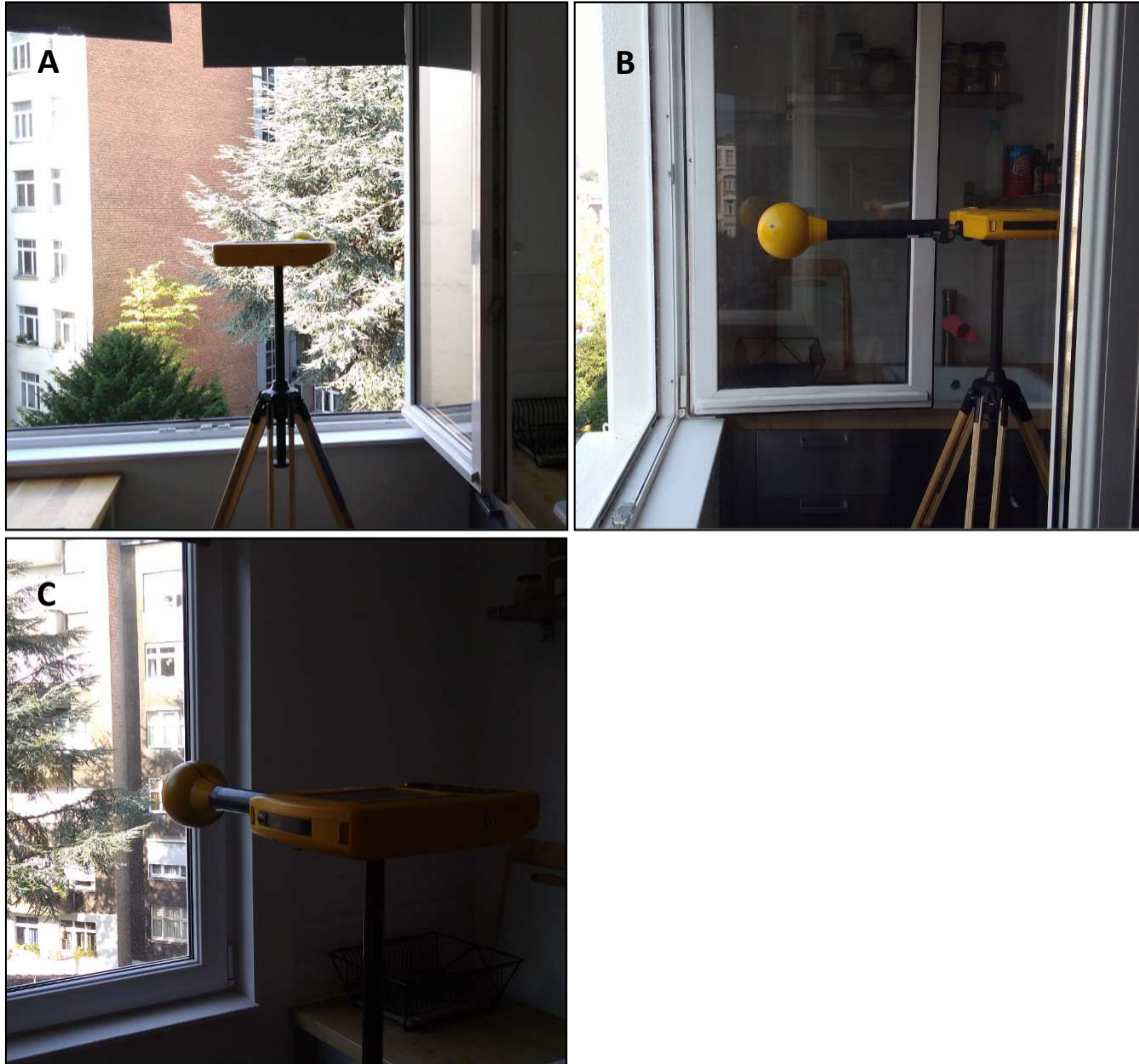
Figuur 24: Voorbeeld van installatie van de meter volgens de drie soorten systematische metingen. A: in het vlak van het venster, open; B: op 50 cm van het venster, open; C: op 50 cm van het venster, gesloten.
