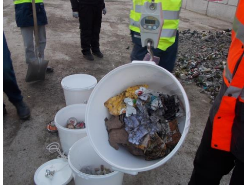
Monsterneming van glasafval met visuele inspectie, deelstaal met de bulldozer, handmatige sortering en wegen van de verschillende fracties die geen glas zijn – © Leefmilieu Brussel
