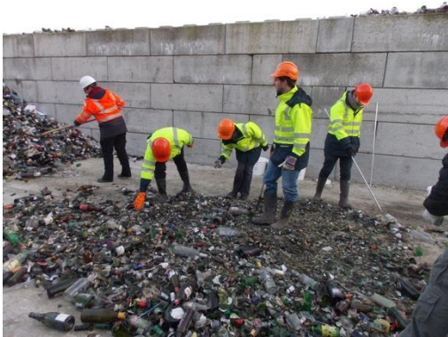
Monsterneming van glasafval met visuele inspectie, deelstaal met de bulldozer, handmatige sortering en wegen van de verschillende fracties die geen glas zijn – © Leefmilieu Brussel
