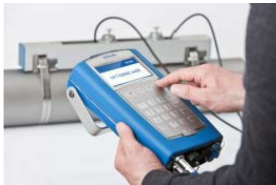
Figuur 4: clamp-on ultrasone debietmeting in praktijk
