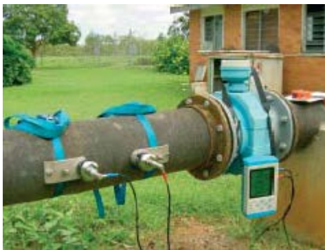
Figuur 4: clamp-on ultrasone debietmeting in praktijk
