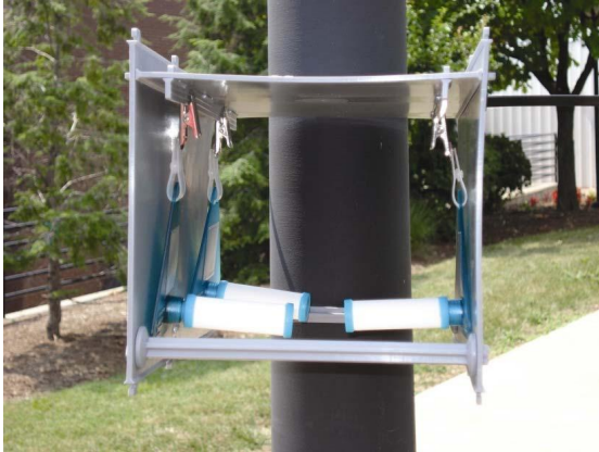
Figuur 7: Beschermende behuizing voor het ophangen van Radiello samplers buiten
