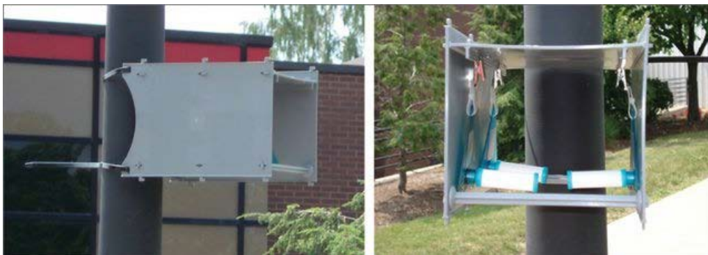
Figuur 5: Afscherming van passieve samplers bij de uitvoering van buitenluchtmetingen
