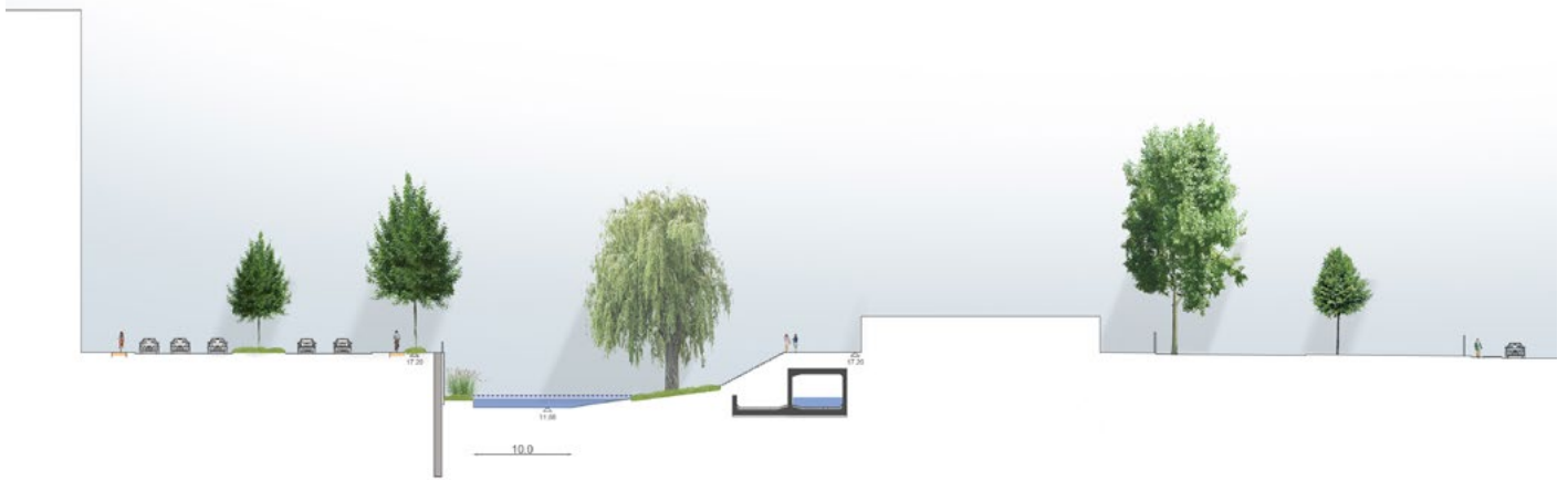
Niveau d'eau de débit 4,8 m 3 /s
