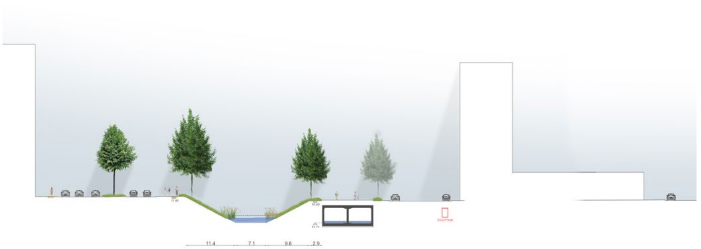
Niveau d'eau de débit 4,8 m 3 /s
