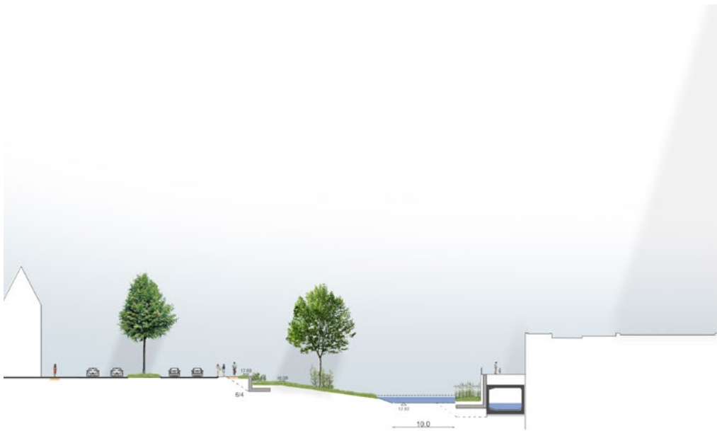
Niveau d'eau de débit 4,8 m³/s
