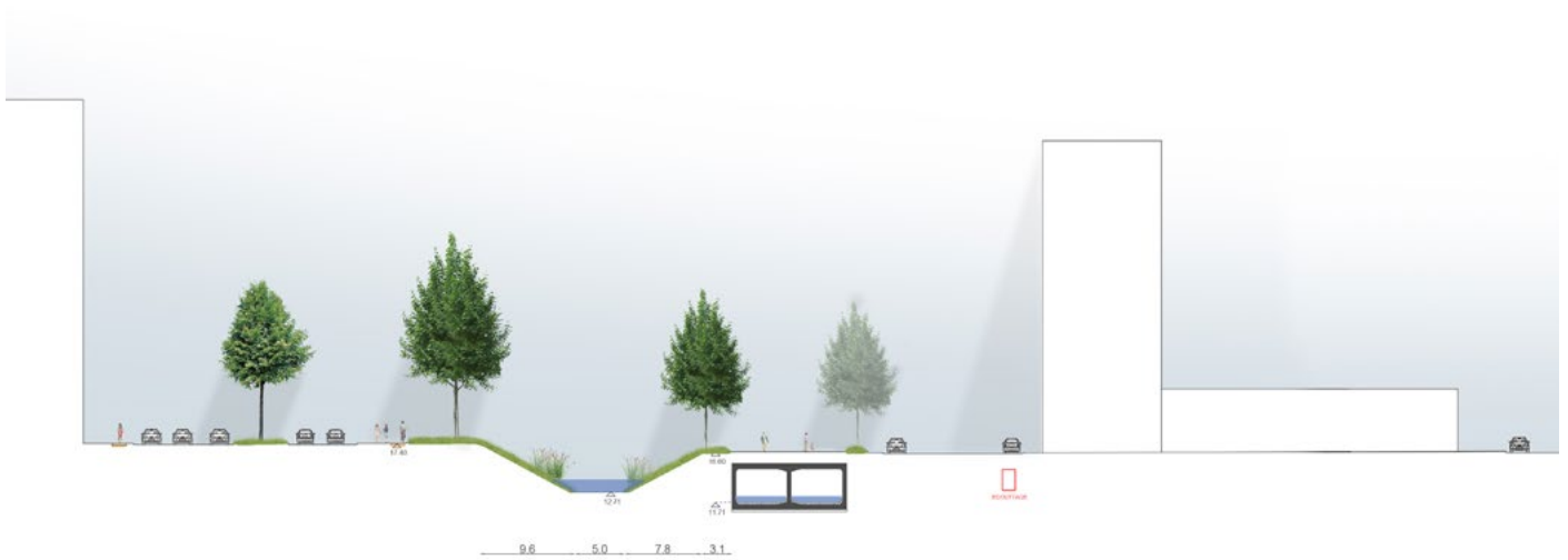
Niveau d'eau de débit 4,8 m 3 /s
