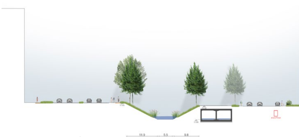
Niveau d'eau de débit 4,8 m 3 /s
