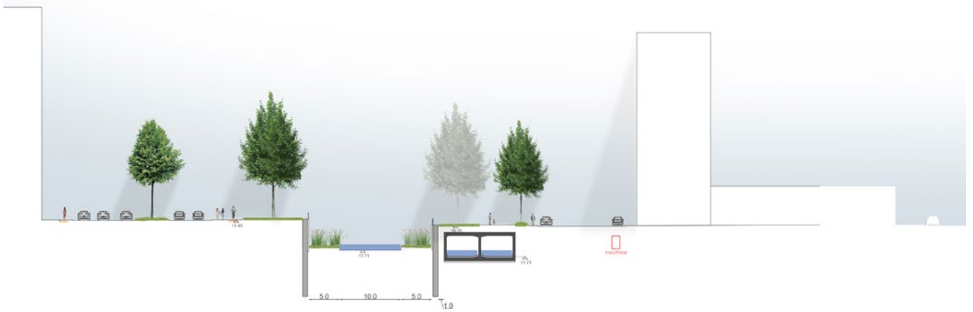
Niveau d'eau de débit 4,8 m³/s
