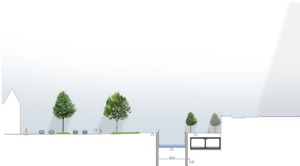
Niveau d'eau de débit 4,8 m 3 /s
