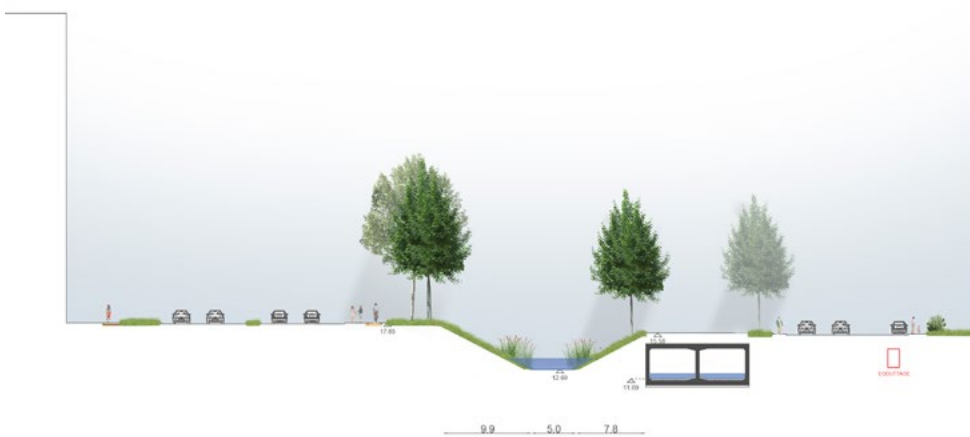
Niveau d'eau de débit 4,8 m 3 /s
